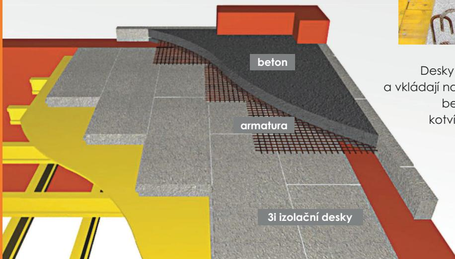
Desky se pokládají na vazbu a vkládají na sraz do připraveného bednění bez přídavných kotvících prvků a následně jsou přibetonovány současně se stropní deskou
